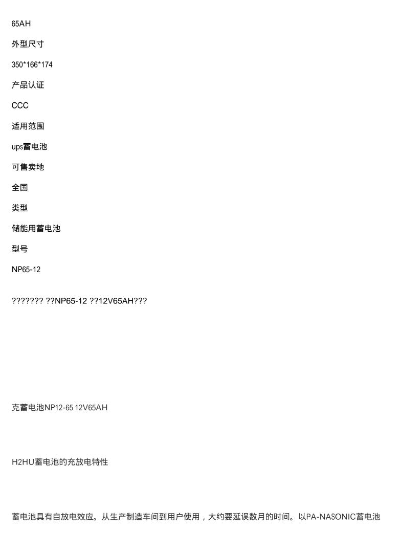
为例,在30 的环境温度下贮藏8个月,蓄电池的残存容量仅为出厂时的一半,因此对于新购买的与UPS 配套的蓄电池,一般要进行一次较长时间的充电,这叫做初充电。蓄电池的初充电电流大小应按0.1C来 充电,蓄电池在放电终了后可进行再充电,这叫正常充电。目前在UPS中普遍采用两种充电方式:浮充和 脉充。所谓浮充电是指整流器的输出与蓄电池并联工作,并同时向负载供电,实际上此时整流器提供的 电流分两路,一路送给负载,另一路送给蓄电池,以补充蓄电池自身内部损耗,浮充充电工作方式接线 简单,对改善UPS输出瞬态响应特性有好处。脉冲充电的特点是充电电流随蓄电池容量而变化,用这种方式充电,可以缩短充电时间。
