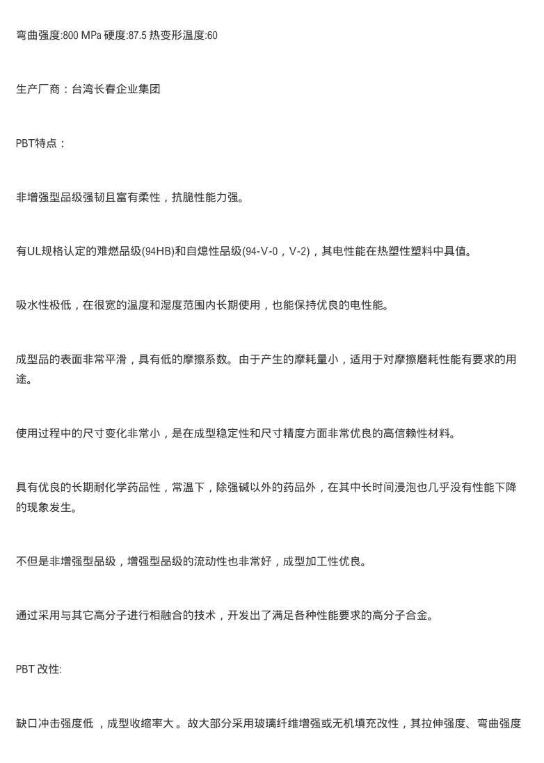
可提高一倍以上,热变形温度也大幅提高。可以在140 下长期工作,玻纤增强后制品纵、横向收缩率不一致,易使制品发生翘曲。
